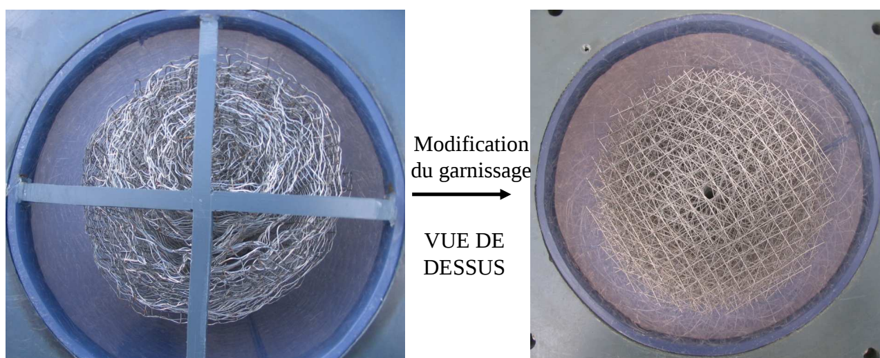
Figure 25. Photographie des deux types de garnissage : grille enroulée (à gauche) et empilement de galettes (à droite).
